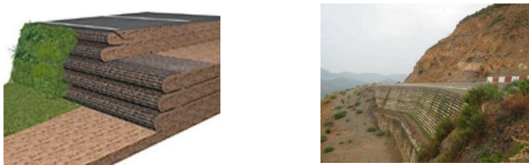
Figure 1.17 Murs en éléments de parements flexibles
