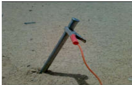
Fig.VI.4 Enfoncement incorrect de l'électrode dans le sol (AL-Menshed 2011).
