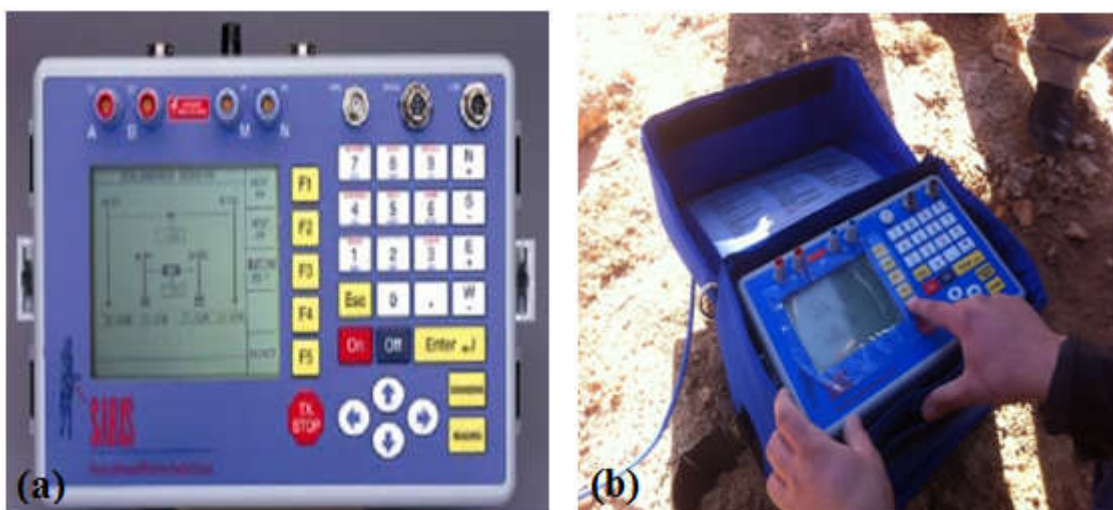
Fig.VI.2 a et b résistivimètre SARIS de Scintrex.
