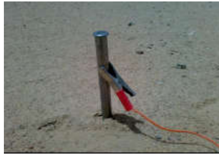
Fig.VI.3 Mauvaise connexion entre l'électrode et le câble (ou la pince) (AL-Menshed 2011).
