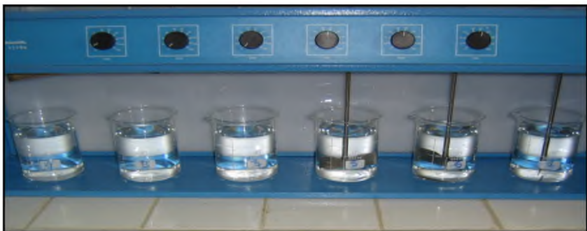
Figure 19 : Essai « Jar-Test » flocculateur de laboratoire Larhyss, (Hecini, 2008)
