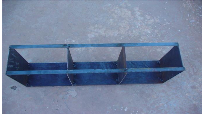
Figure III.9 Support métallique avec murs séparateurs
