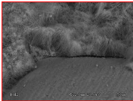
Figure II.16 : Hydrates fibreux à l'interface pâte/granulat (grandissement 600×) [125]
