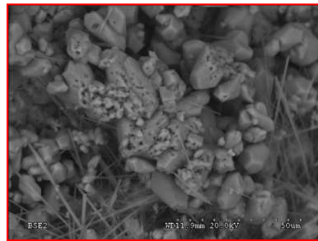
Figure II.17 : Calcite et aiguilles d'ettringite à la surface de la fissure (grandissement 1000×) [125]
