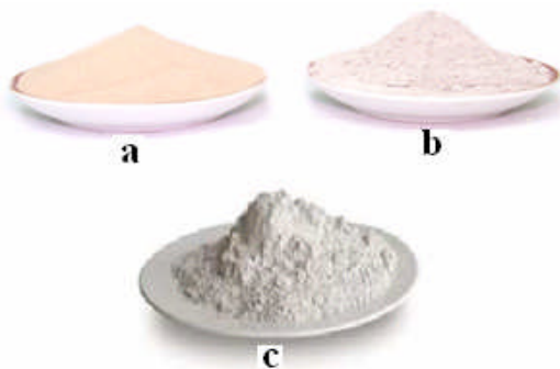
Figure III.2 : Échantillon du sable de dune, (a) : Sable de dune non broyé, (b) «F 1 » et (c) «F 2 » : Sable de dune finement broyé
