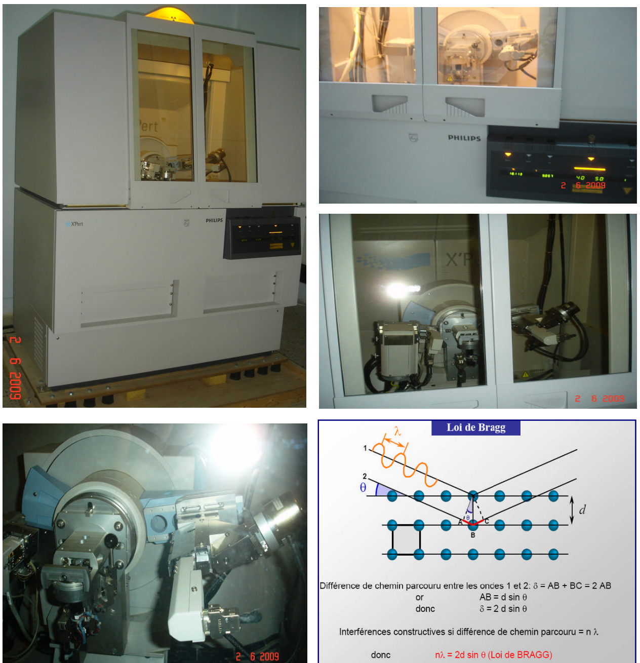
Figure III.4 : Diffractomètre de poudre à compteur courbe et la loi de Bragg
