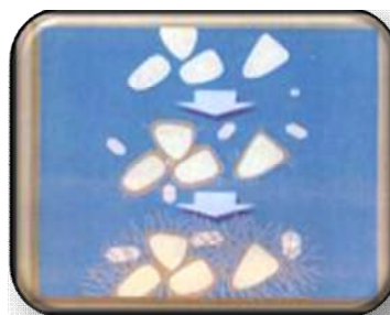
Figure I.6 : Effet de la fumée de silice sur l'hydratation du ciment [63]
