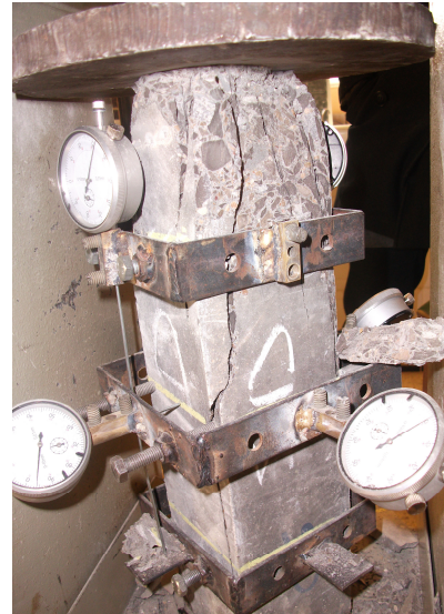
Figure 5-15 : Les déformations mesurées Sur l'éprouvette pendant la compression
