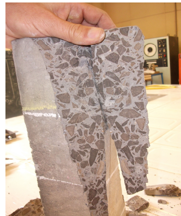
Figure 5-29: Ruine de l'éprouvette dans la partie du granulat
