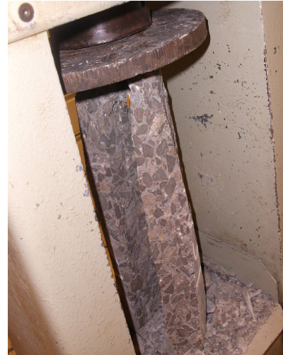
Figure:5-13 : Epreuve brisée par la compression
