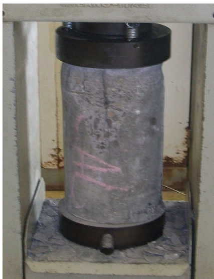
Figure 5-5 : Mode de rupture d'éprouvettes cubique et cylindrique soumises à la compression.
