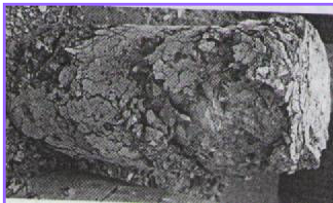
Figure 6-9 : Epreuve 16x32 d'un béton avec de fumée de silice chauffé à 900C° [43].
