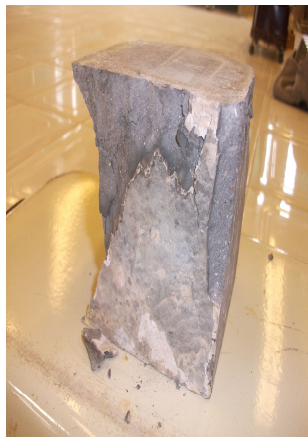
Figure 5-28: Ruine de l'éprouvette dans la partie de mortier
