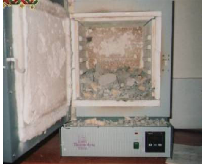
Figure 6-8 : Endommagement total à 900C°
