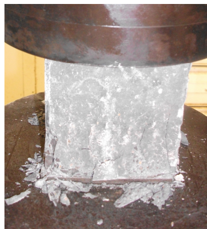
Figure 5-5 : Mode de rupture d'éprouvettes cubique et cylindrique soumises à la compression.
