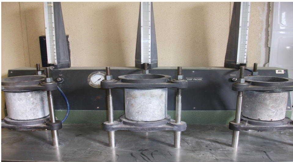
Figure 6-3 : Le dispositif de perméabilimètre
