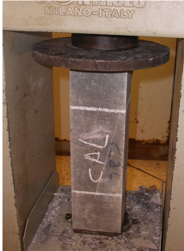
Figure 5-12 : L'emplacement d'éprouvette soumis à la compression
