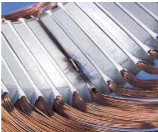
Fig. I.5 : Exemples de dégâts dus au défaut de court-circuit statorique d'un moteur asynchrone.
