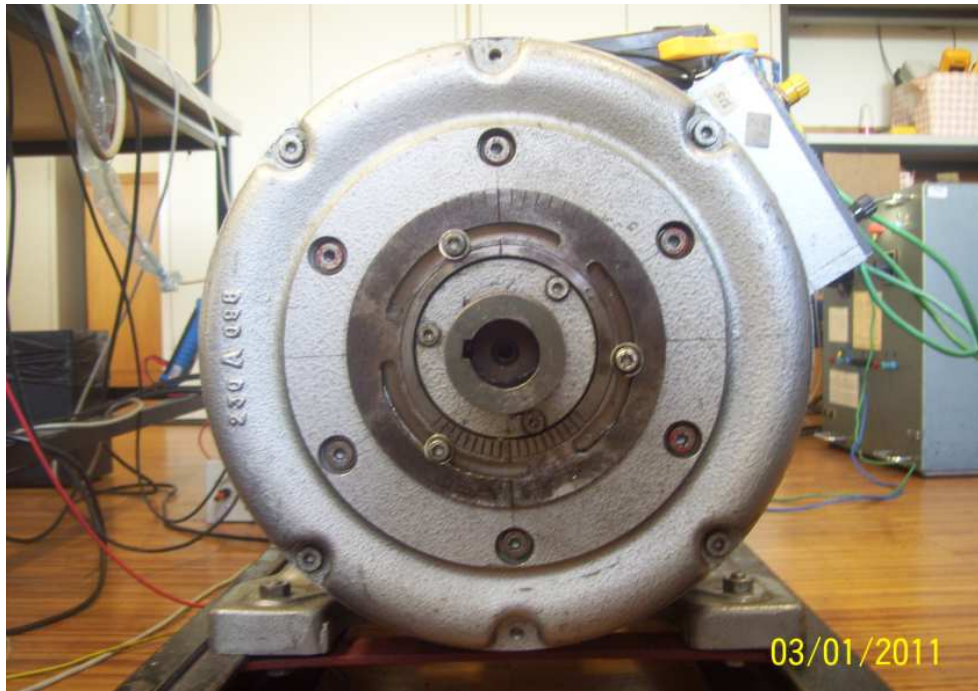
Fig. V.2 : Mécanisme spécial de changement de l'excentricité statique.
