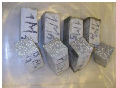
Photo.13 : les éprouvettes après l'essai de flexion
