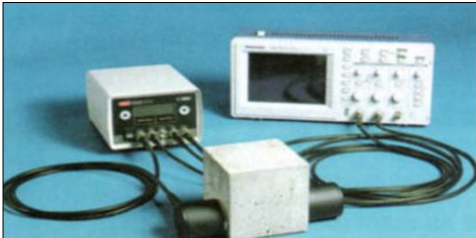
Photo (3.2) : Appareil d'auscultation sonore 58-E48 avec oscilloscope
