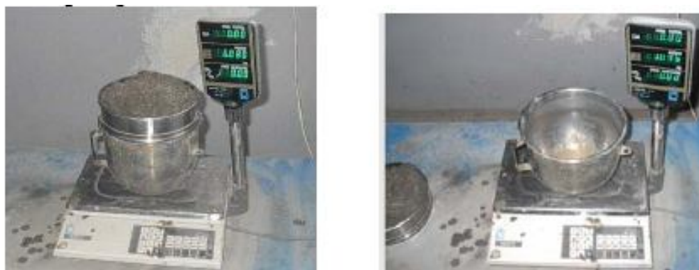
Photo2. 3 - Représentation de l'essai de stabilité au tamis
