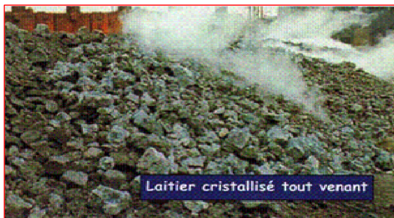
Figure 2.9 : laitier cristallisé tout-venant (Alexandre et Sebileau, [40])
