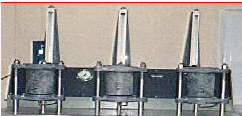
Figure 4.52 Dispositif expérimental utilisé pour mesurer la perméabilité de béton
