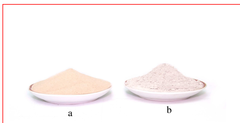
Figure 3.2 : Échantillon du sable de dune utilisé comme ajout cimentaire (a) sable de dune non broyé, (b) sable de dune broyé.
