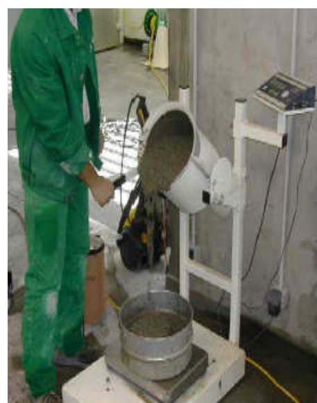
Photo 2.4 : Dispositif de l'essai de stabilité au tamis [1].
