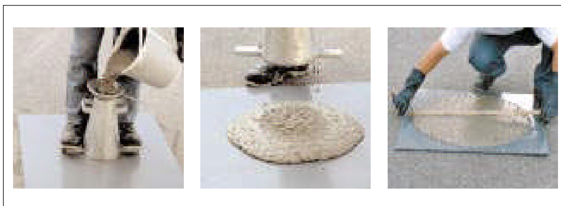
Photo 2.1 : Les différentes étapes de l'essai d'étalement [20].
