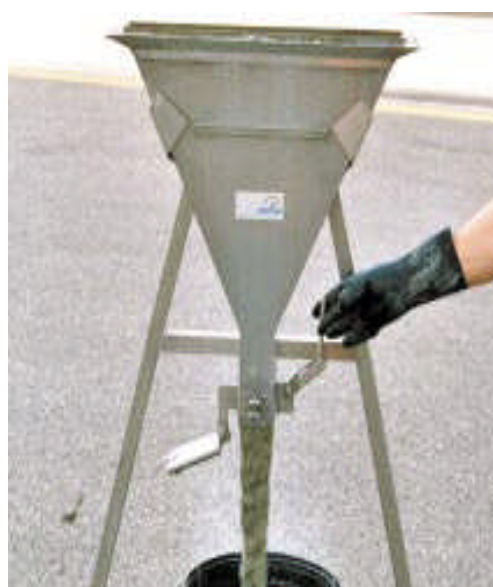
Photo 2.5 : L'écoulement du BAP durant l'essai de l'entonnoir [20].
