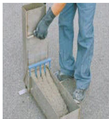
Photo 2.2 : L'écoulement de BAP dans la boîte en «L» [20].
