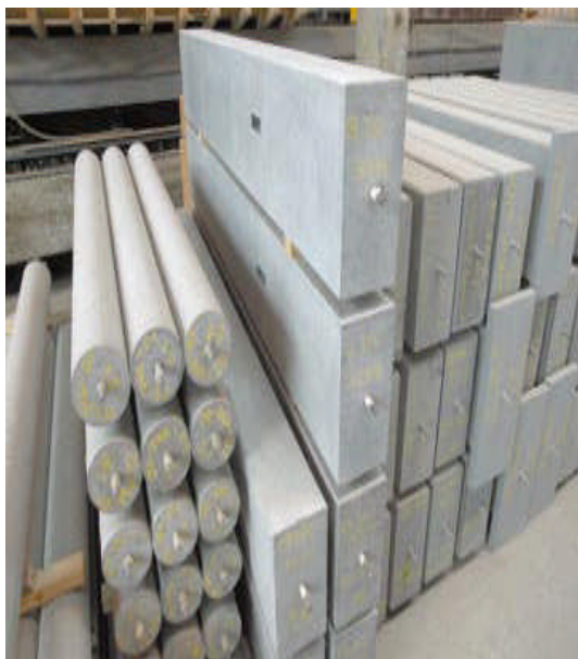
Photo 1.4 : Eléments préfabriqués de BAP possèdent de surfaces bien finies.
