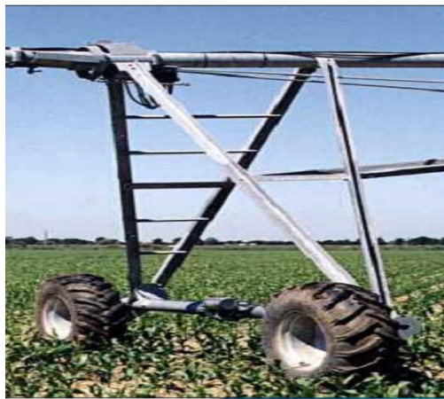
Fig. I.15: Tour d'un pivot rotative
