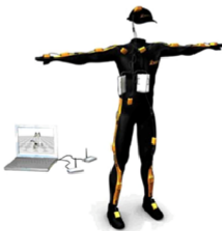
Figure 2.22: Placement des capteurs inertiels.
