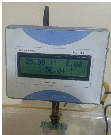
Figure 4.26 Affichage local de niveau Château d'eau demi plein
