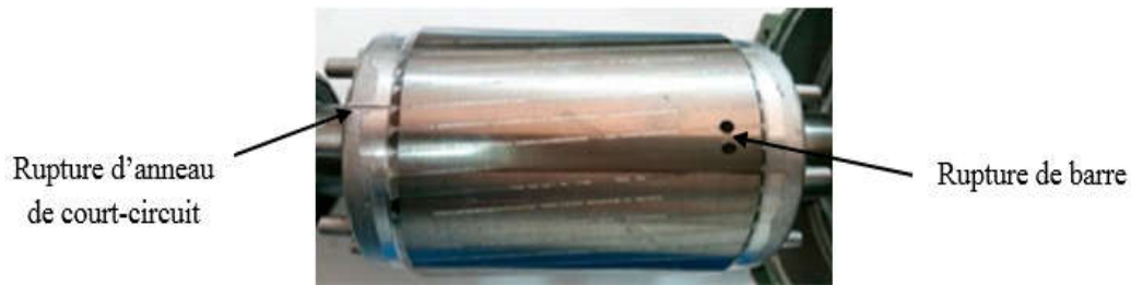
Figure 1.4. Rotor à cage avec rupture de deux barres.
