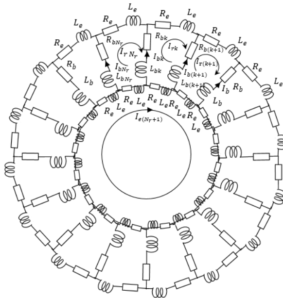
Figure 2.4. Circuit électrique des mailles rotorique élémentaires.
