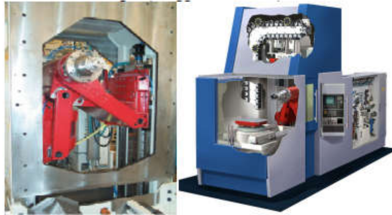
Fig. 1.12 : Centre d'usinage à cinématique parallèle GENIUS 500 (Source : Cross Hüller) [28].
