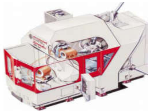
Fig. 1.11 : Centre d'usinage à structure parallèle SKM 400 (Source Starragheckert) [28].
