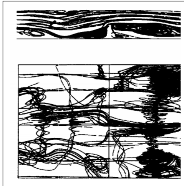
FIGURE I .40- Vue des tourbillons longitudinaux (en haut) et transversaux (en bas) [68].
