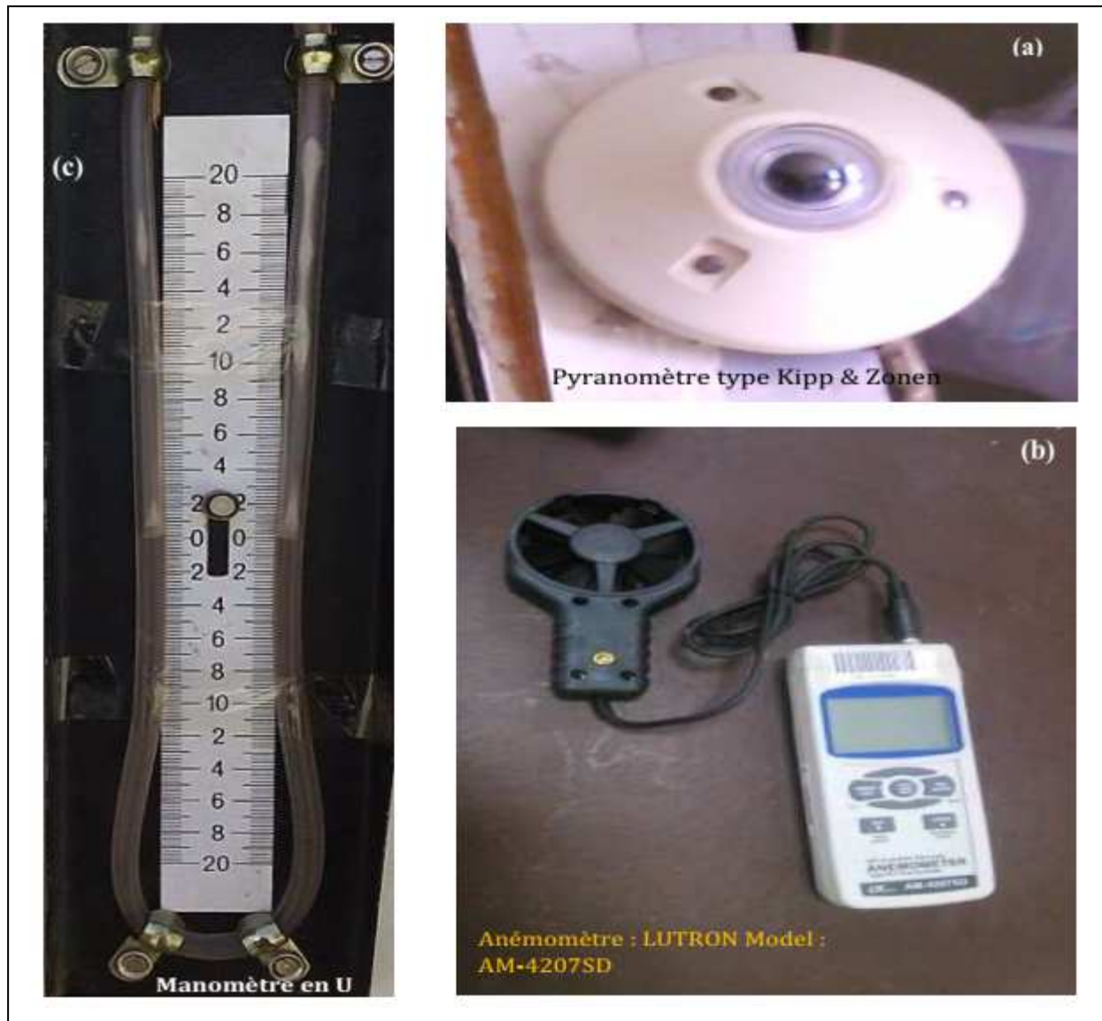
FIGURE III .11- Photographie des différents instruments de mesure utilisés (a) Pyranomètre, (b) Anémomètre, (c) Manomètre en U
