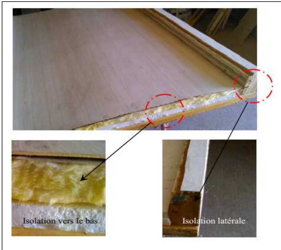
FIGURE III .1- Isolation thermique du capteur plan à air
