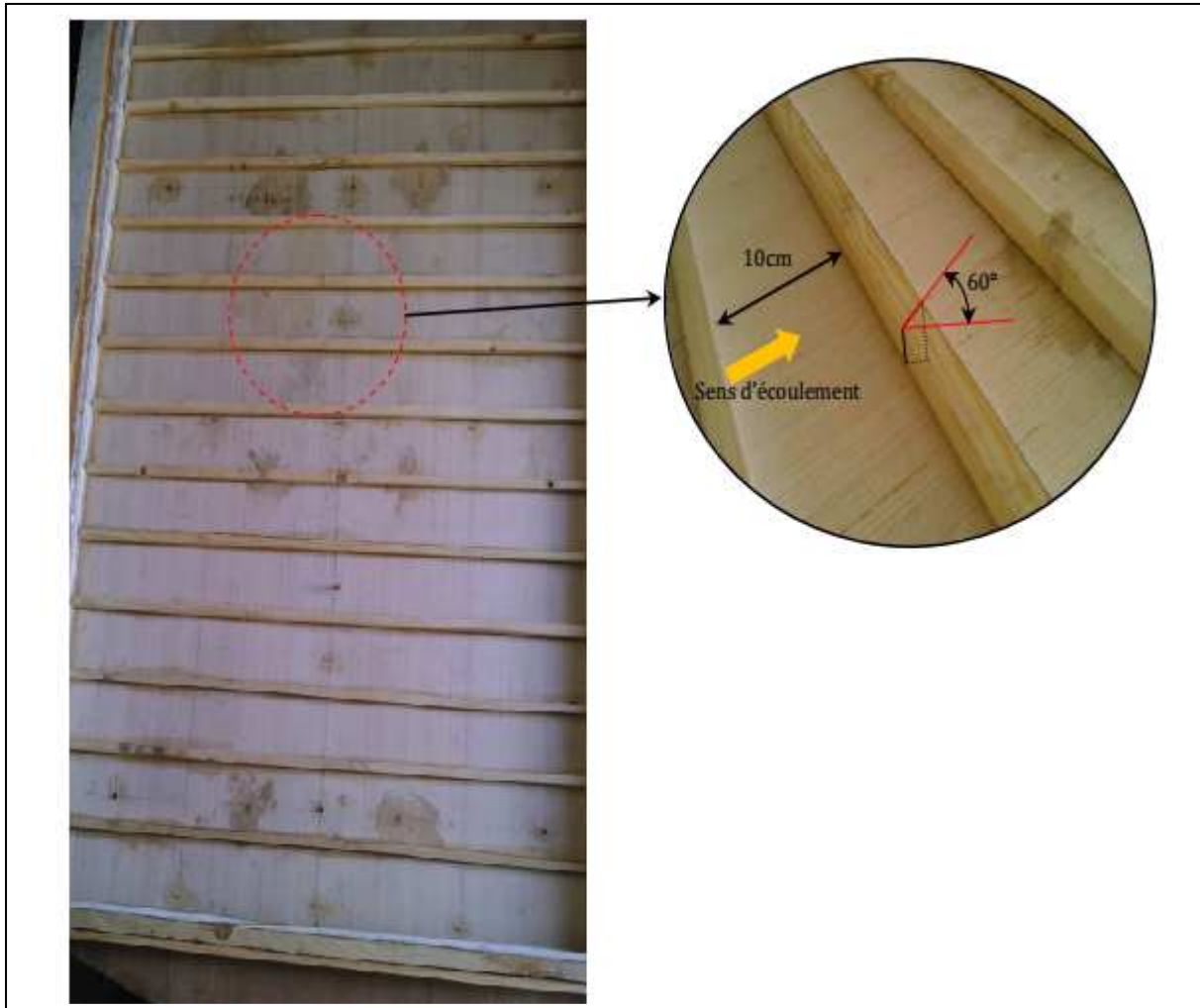
FIGURE III .3- Forme et emplacement des chicanes étudiées.
