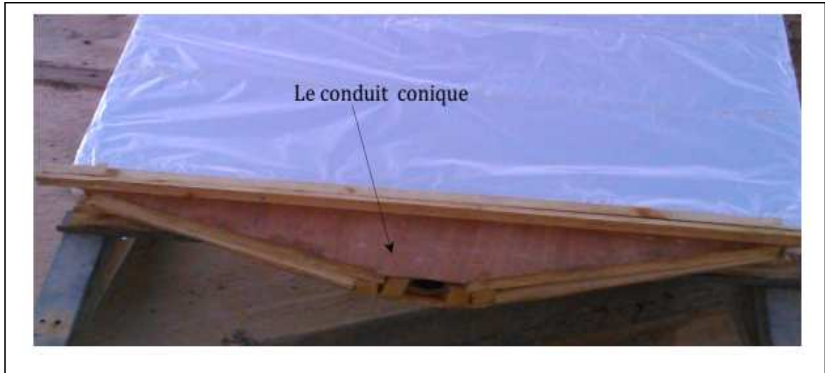
FIGURE III .6- Photographie de conduit conique.
