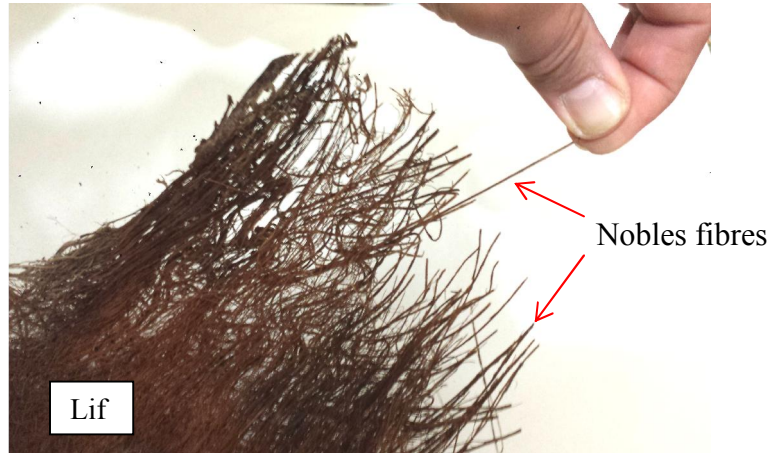
Figure II.5 : Séparation des fibres nobles du Lif
