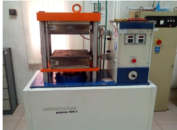
Figure III.10 : Presse à compression à chaud
