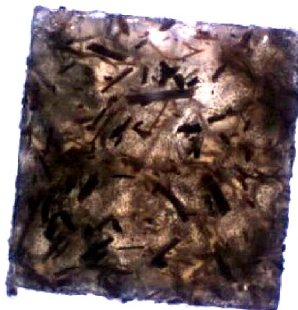
Figure III.29 : Micrographie optique du composite PPL (x10)
