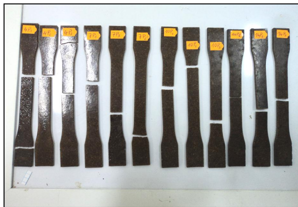
Figures III.21 : Éprouvettes de traction après rupture.
