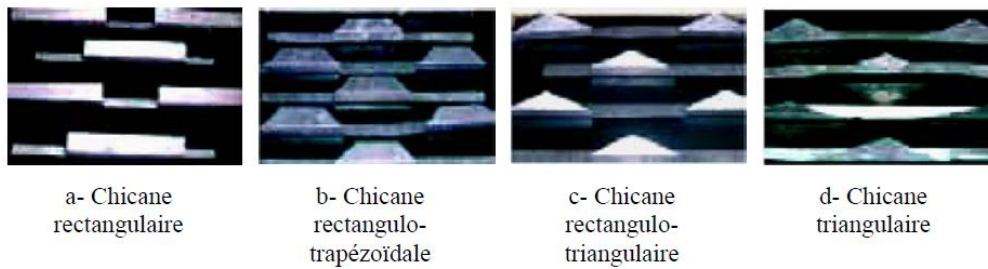
Figure 11. Différentes configurations des chicanes testées par Chouchane et al. [25, 26]
