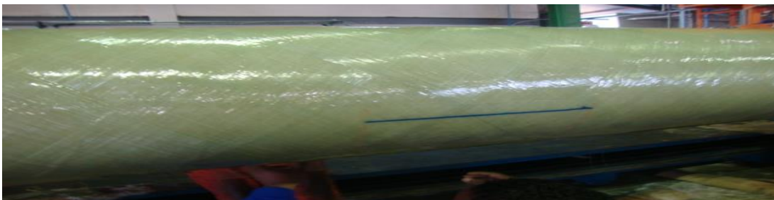
b) Vue générale avec les extrémités de film du pré-défaut.
