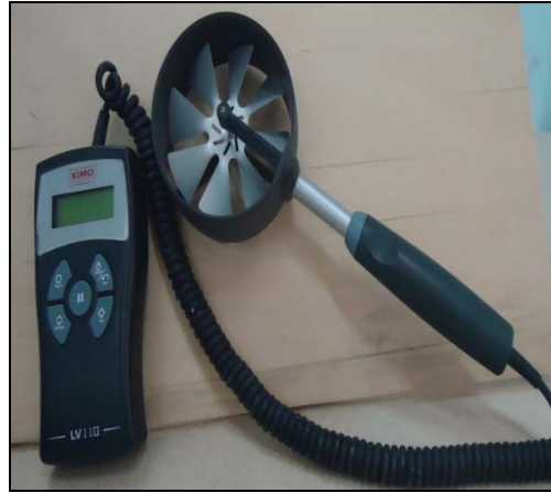
Figure III.14 : Anémomètre à hélice de type KIMO LV 110 pour mesurer la vitesse de et la température de l'air
