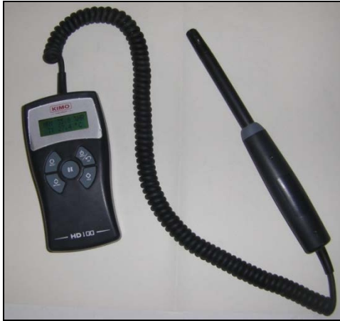
Figure III.13 : Hygromètre de type KIMO HD 100 pour mesurer l'humidité relative et la température de l'air
