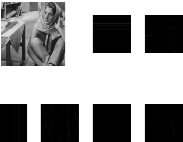
FIGURE 7.6 – Décomposition de l'image originale au niveau j = 1
