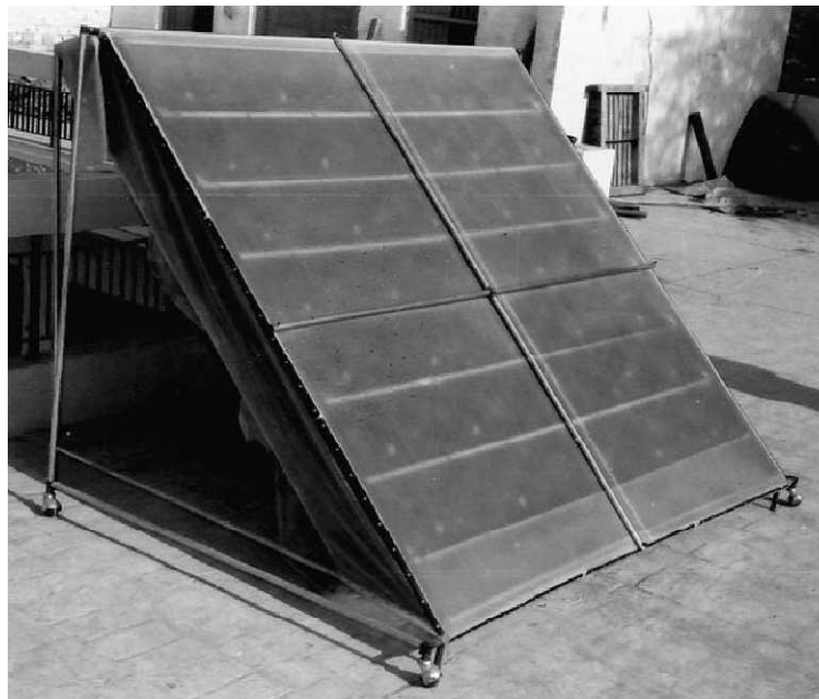
Figure I.28 : Schéma d'un séchoir solaire direct à convection naturelle (Singh et al. 2004)
