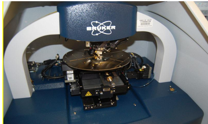
Figure 2.15: Dektak XT stylus profiler (Bruker).
