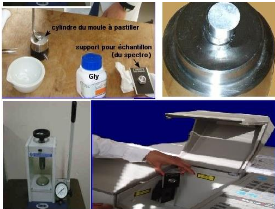
Figure II. 5 : Schéma de l'appareil infrarouge et ces accessoires (Presse + pastilleuse)
