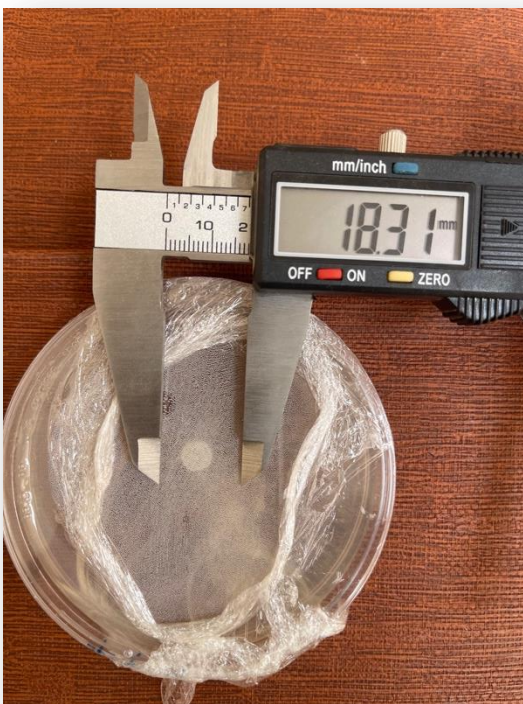
Figure N°29 : la mesure d'une boite traiter par Tachigazhol après 6 jours (Photo original)
