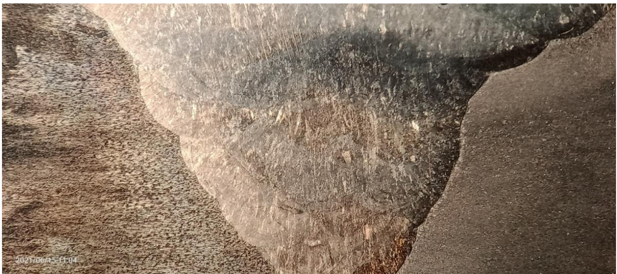
Figure IV.23 : Morphologie du joint soudé après les différentes passes en utilisant deux électrodes différentes.
