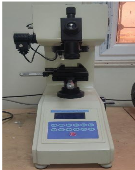
Figure III.3. Microduromètre de type HVS-1000 Z.
