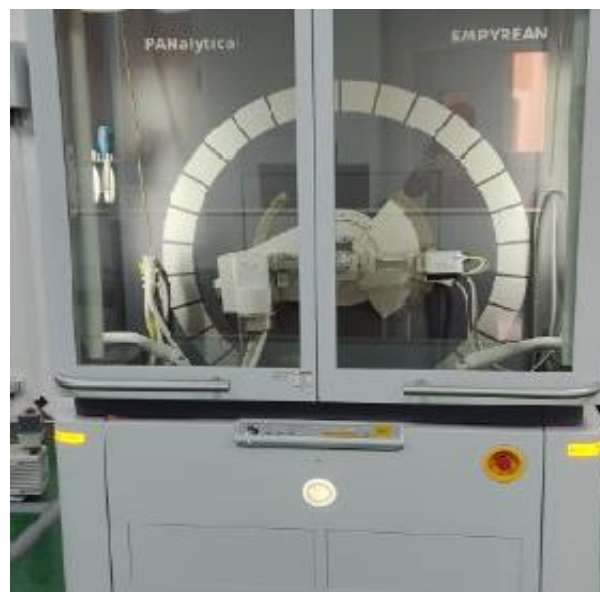
Figure III.6 : Diffractomètre de rayons X de type Empyrean (3 ème génération).
