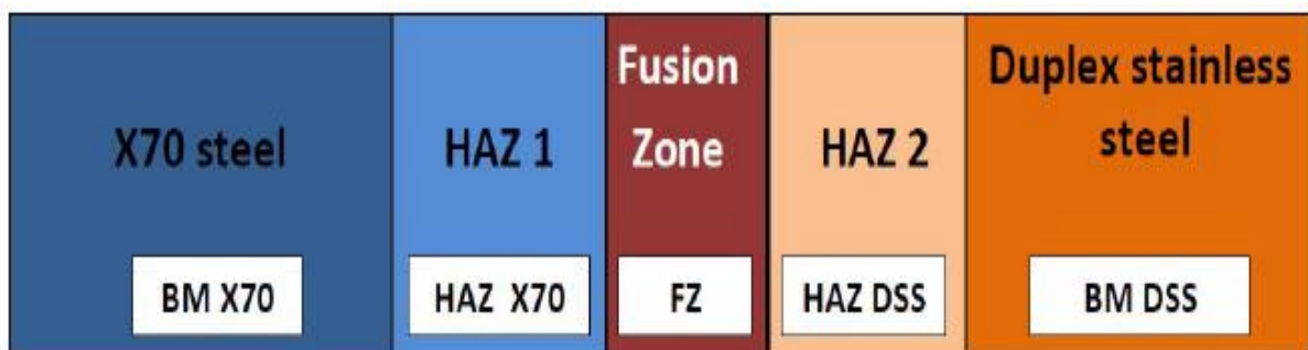
Figure IV.6 : Représentation schématique du joint soudé avec différentes zones (BM : Métal de base, HAZ : Zone affectée par la chaleur et FZ : Zone de fusion).
