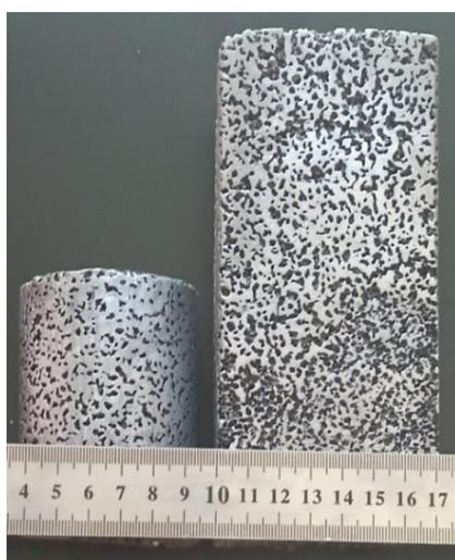
**Figure 2. 17 : Surface latérale des échantillons avec une taille de pores de (1,5–2 mm) obtenue**
