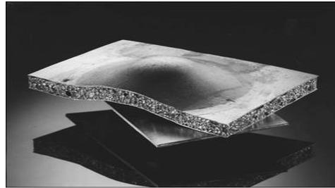
**Figure 1.24 : Panneau sandwich avec âme en mousse d'aluminium (épaisseur 12 mm) et deux tôles d'acier**
