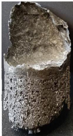
**Figure : 2.15** Défaut de solidification de la mousse d'aluminium
