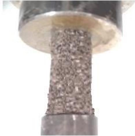
**Figure 3.13 : Cylindre - modes de déformation d'éprouvette PPI 20**
