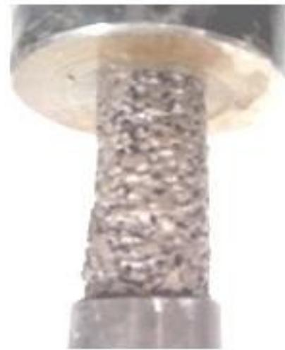
**Figure 3.14 : Cylindre - modes de déformation d'éprouvette PPI 15**
