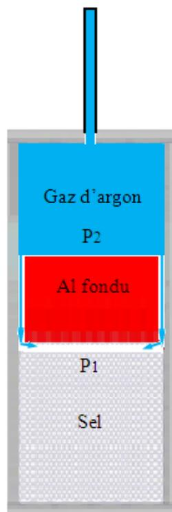
Figure 2.12 ; Principe de l'infiltration par un gaz à faible débit
