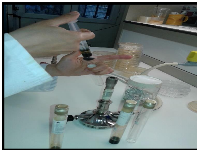
Figure 46 : Stérilisation des extraits à travers un filtre à membrane
