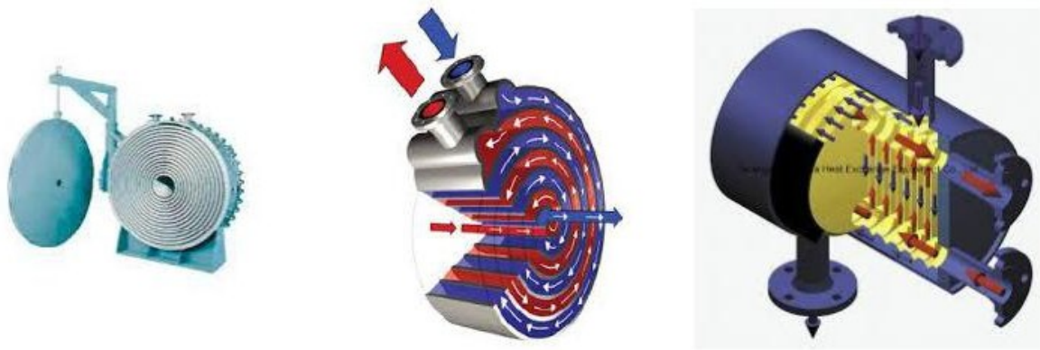
Figure II.6: Les échangeurs de chaleur spiralée [29].
