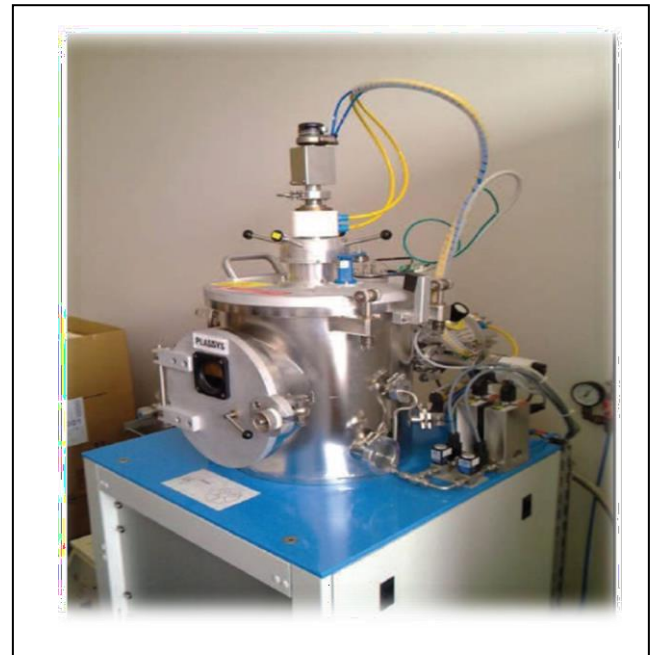
Figure (II.5) : Bâti de pulvérisation cathodique en continu [5].
