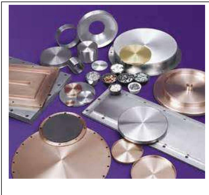
Figure (II.4) : Quelques types de cibles utilisées en pulvérisation cathodique [4].
