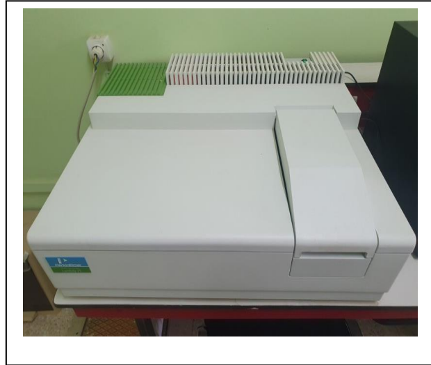
Figure (II.17): Dispositif expérimental de la spectroscopie UV-visible.
