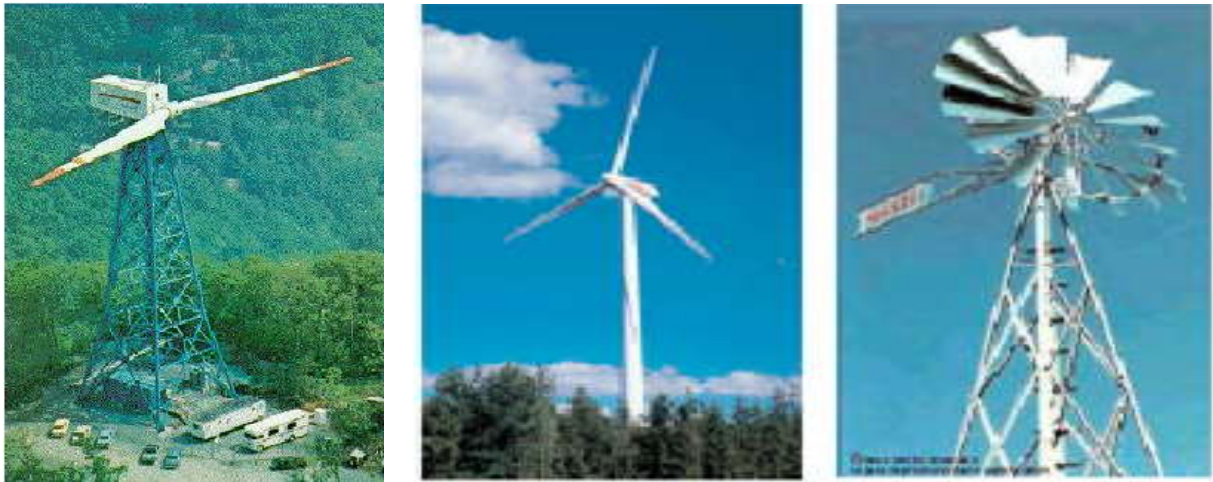
Figure I. 3: Eoliennes à axe horizontal [Abd 2007]
