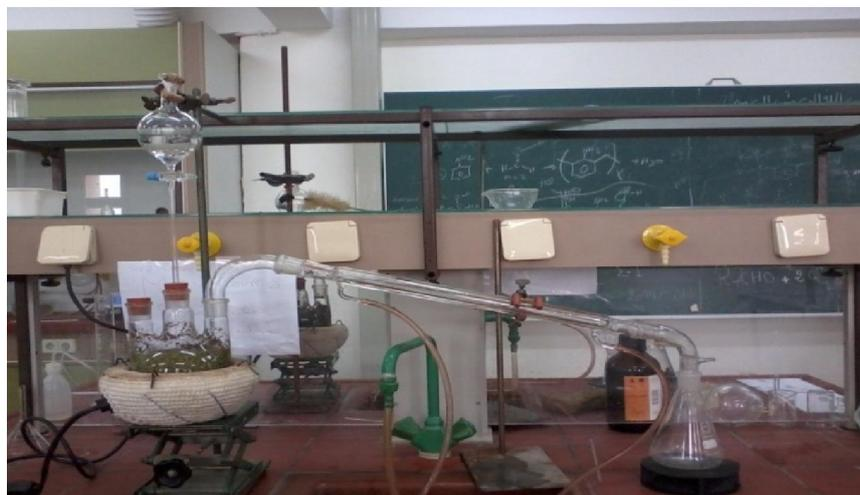
**Figure 10:** Montage d'hydrodistillation (extraction des huiles essentielles).
