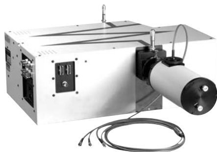
77529 F/# Matcher, avec Fibre multivoie, montée sur Monochromateur MS257™.
