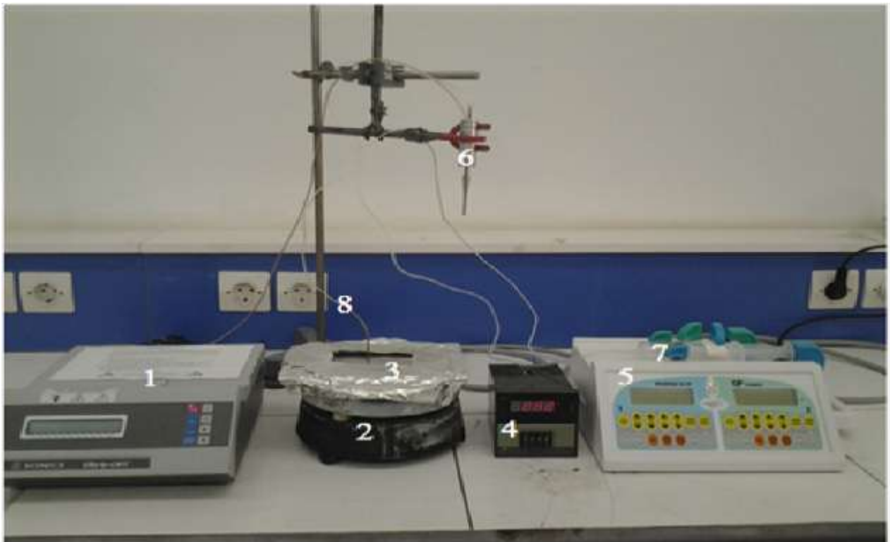
Figure III.1 : schéma du banc de dépôt de couche mince par la technique spray pyrolyse ultrasonique.
