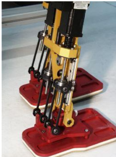
Figure 2-23 : Cinématique des chevilles du robot BIP [9].
